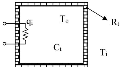
6-) O modelo mais simples do sistema de arrefecimento de uma sala considera as paredes como resistências térmicas puras e a temperatura da sala como sendo uniforme. Supondo que o ar condicionado retira calor a uma taxa  $q_i$ , obtenha as F.T. para o sistema térmico da figura. São conhecidos  $V$  (volume total da sala),  $A$  (área total de troca de calor das paredes da sala),  $e$  (espessura das paredes da sala),  $\rho_{ar}$  (densidade do ar) e  $c_{ar}$  (calor específico do ar).
