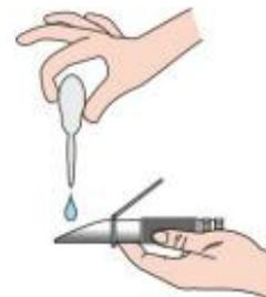
2. Pingue duas gotas de água destilada sobre o prisma e feche a tampa
