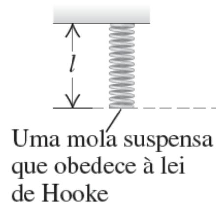
(b) Um corpo suspenso na extremidade da mola está em equilíbrio quando a força da mola de baixo para cima possui módulo igual ao do peso do corpo.
