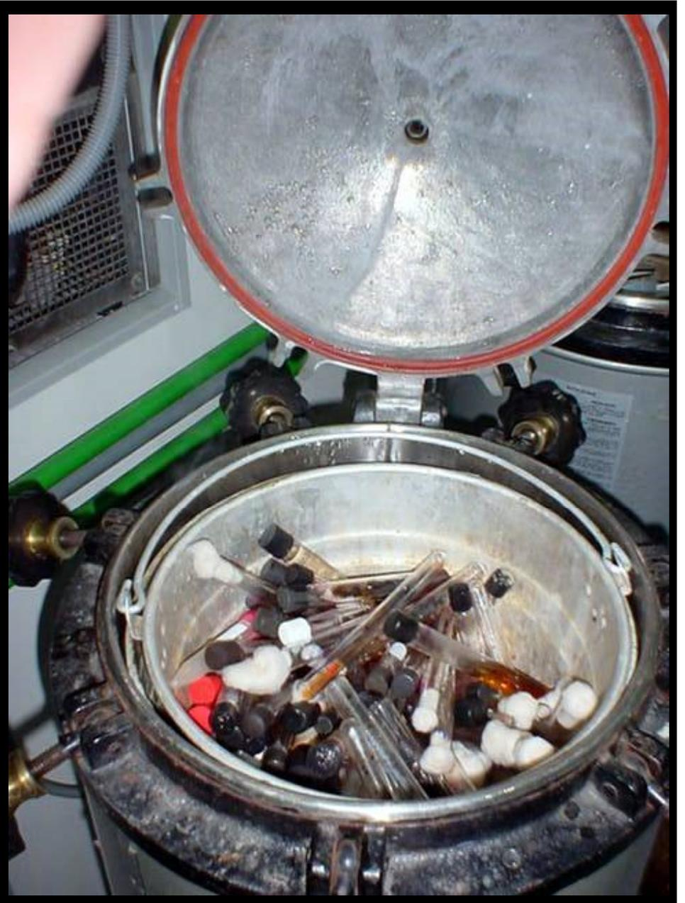
Autoclave: calor úmido - 120° C x 20 minutos (1 atmosfera)
