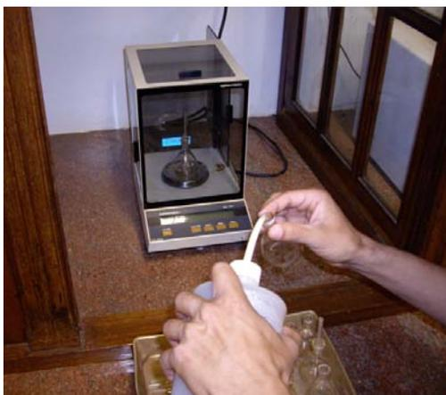
Figura 22 – Pesagem dos picnômetros com água, utilizando balança analítica
