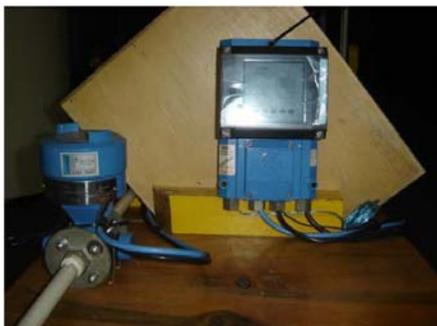
Figura 16 – Medidor de vazão eletromagnético indutivo
