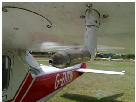
Como medir a velocidade de escoamento do fluido? Como usar o tubo de Pitot como um aparelho de medida num avião? Antes de iniciar o experimento. Onde a pressão é maior e menor que a atmosférica?
