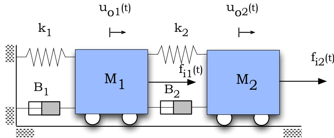
Obtenha as F.T. relacionando as saídas  $u_{o1}(t)$  e  $u_{o2}(t)$  com as entradas  $f_{i1}(t)$  e  $f_{i2}(t)$ . Todos os elementos são puros e ideais.
