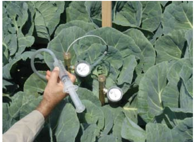
Fig. 12. Manutenção de tensiômetro no campo por meio de uma bomba de vácuo manual tipo seringa.
