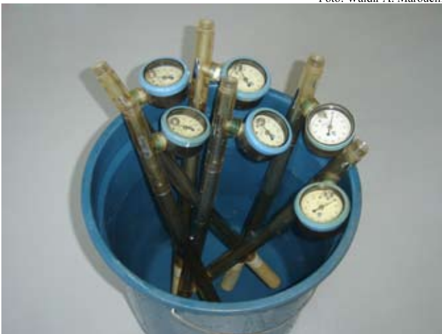
Fig. 5 - Saturação de tensiômetros (cápsulas porosas) em recipiente com água.
