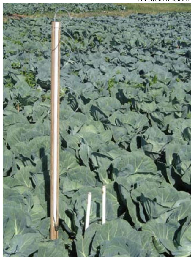
Fig. 4. Tensiômetros com vacuômetro de mercúrio instalado em lavoura de repolho.
