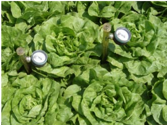
Fig. 9. Estação de controle com tensiômetros instalados a 50% e 100% da profundidade efetiva do sistema radicular de uma lavoura de alface irrigada por gotejamento.
