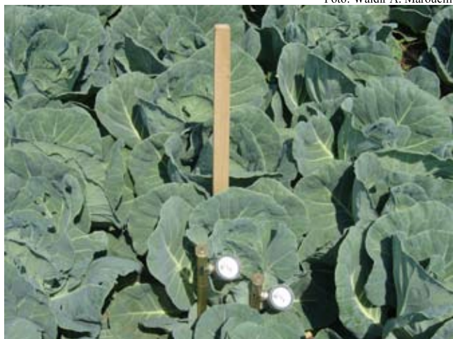
Fig. 13. Estação de controle com tensiômetros devidamente sinalizados por uma estaca de madeira.
