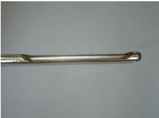
Fig. 11. Trado de punção, tipo meia-cana, para a instalação de tensiômetros.
