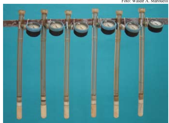
Fig. 8 - Evaporação de água através da cápsula porosa visando verificar problemas de entrada de ar em tensiômetros.
