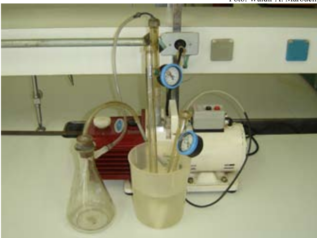
Fig. 6 - Bomba de vácuo para saturação de tensiômetros.
