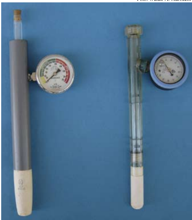
Fig. 1. Tensiômetros com vacuômetros metálico tipo Bourdon.
