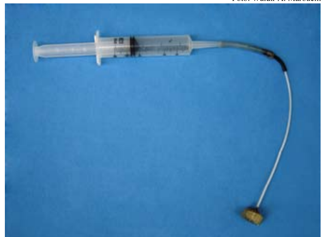
Fig. 7 - Seringa do tipo hospitalar adaptada para saturação de tensiômetros
