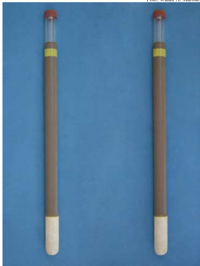
Fig. 2. Tensiômetros de punção para leitura com tensímetro.
