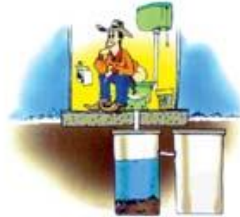
Sanitário com fossa séptica
