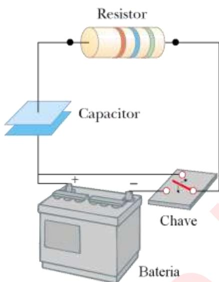
Alternando-se a posição da Chave comutadora, pode-se ligar e desligar a fonte no sistema
