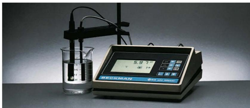
**Figura 15.2** Em laboratório, é muito comum usar um aparelho medidor de pH (pHmetro) para avaliar o pH de uma solução. Embora muitos aparelhos medidores de pH tenham escalas com valores de 1 a 14, o valor do pH na verdade pode ser menor que 1 e maior que 14.
