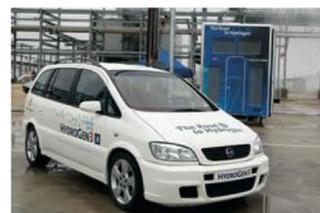
Um automóvel movido por uma célula a combustível a hidrogênio fabricado pela General Motors.
