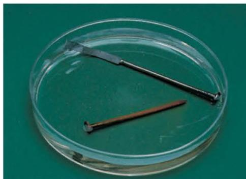
**Figura 18.15** Um prego de ferro que está protegido catodicamente por um pedaço de folha de zinco não enferruja em água, ao passo que um prego de ferro que não está protegido enferruja rapidamente.
