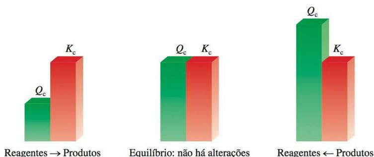
**Figura 14.5** O sentido de uma reação reversível até atingir o equilíbrio depende dos valores relativos de  $Q_c$  e  $K_c$ . Repare que  $K_c$  é uma constante a uma dada temperatura, mas  $Q_c$  varia de acordo com as quantidades relativas presentes de reagentes e de produtos.
