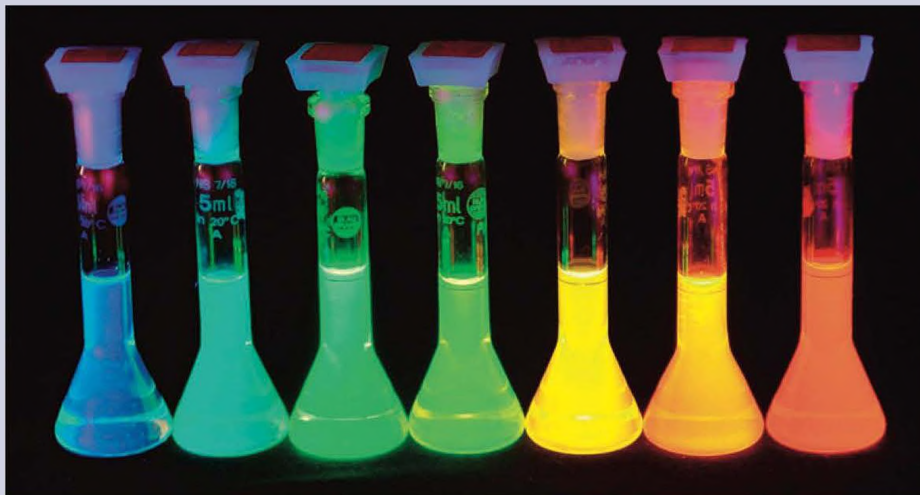
Emissões de soluções dispersas de pontos quânticos de CdSe dispostas da esquerda para a direita, em ordem crescente do diâmetro (2 nm a 7 nm).
