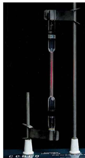
Figura 7.7 Cor emitida pelos átomos de hidrogênio em um tubo de descarga. A cor observada resulta da combinação das cores emitidas no espectro visível.
