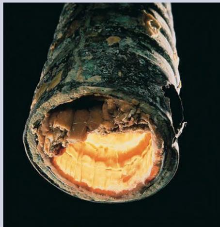
Incrustação que enche quase completamente este cano de água quente. O depósito é constituído principalmente por  $\text{CaCO}_3$  e algum  $\text{MgCO}_3$ .
