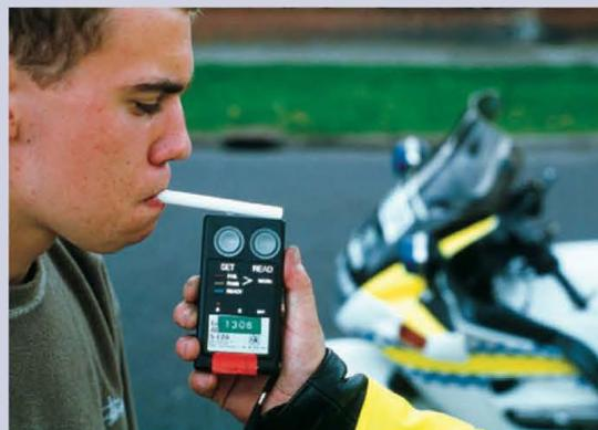
Um condutor fazendo o teste do bafômetro em um etilômetro portátil.
