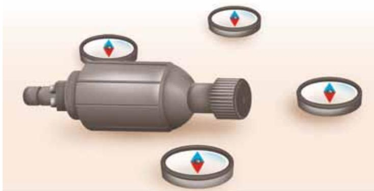
3. Ainda com a bússola próxima do dínamo, comece a girar lentamente seu eixo.
