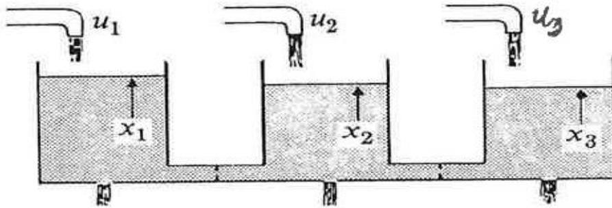
$$\frac{d}{dt} \begin{bmatrix} x_1 \\ x_2 \\ x_3 \end{bmatrix} = \begin{bmatrix} -3 & 1 & 0 \\ 2 & -3 & 2 \\ 0 & 1 & -3 \end{bmatrix} \begin{bmatrix} x_1 \\ x_2 \\ x_3 \end{bmatrix} + \begin{bmatrix} u_1 \\ u_2 \\ u_3 \end{bmatrix}$$
