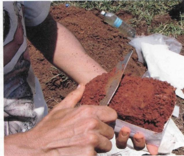
Se, para a análise granulométrica, precisamos cavar, destorroar, secar, Agitar, peneirar, dispersar e pipetar o solo, para as determinações de laboratório da estrutura, a recomendação é alterar o menos possível a amostra, isto é, ou trabalhamos diretamente no campo, ou no laboratório, mas com blocos de solo de certo volume, aos quais chamamos de **“amostras indeformadas”**.
