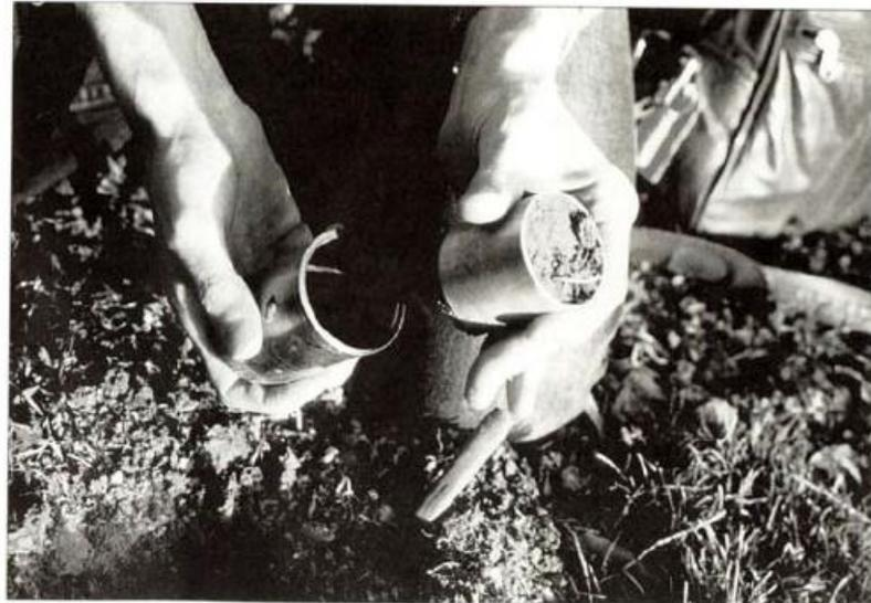
Coleta de amostra de solo em anel volumétrico
