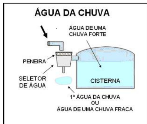
Figura 13: Esquema simplificado para reutilização da água da chuva
