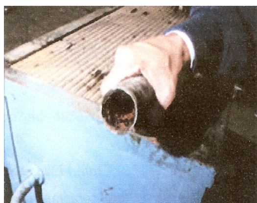
Figura 79: Cano com "craca" em seu interior
