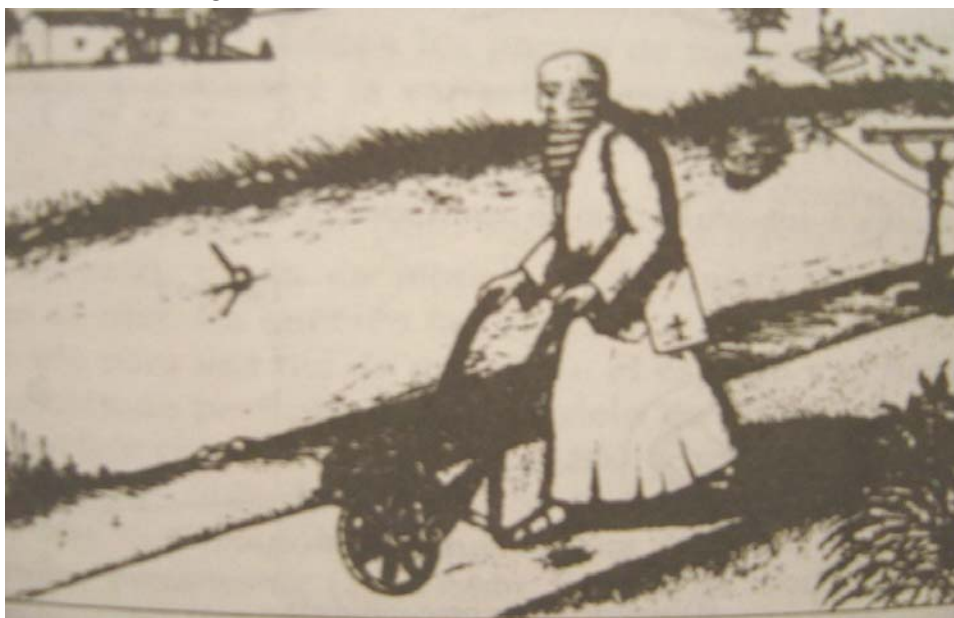
Figura 1. Leonardo da Vinci avaliando as incertezas da velocidade de um rio. Método: vara lastrada boiando na água (peso + bexiga animal inflada), medindo a distância com uma carriola metrada (odômetro) e com canções rítmicas. Fonte: Chow et al (1988).
