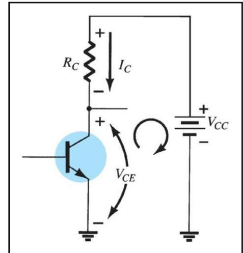
Para a análise CC o circuito pode ser isolado dos valores CA indicados pela substituição dos capacitores por um circuito aberto equivalente porque a reatância capacitiva para  $f = 0\text{ Hz}$  é  $1/(2\pi fC) = \infty$ .
