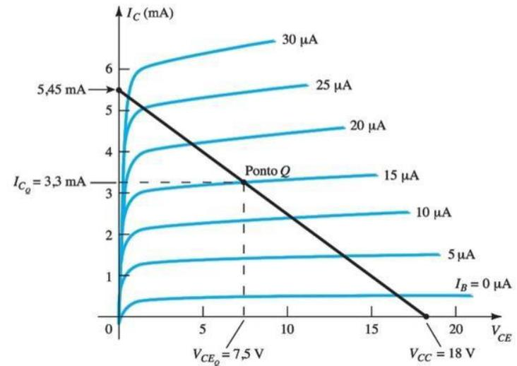
b) Os valores de  $I_{CQ}$  e  $V_{CEQ}$  para um ponto Q na interseção da reta de carga com uma corrente de base de  $15 \mu\text{A}$ .
