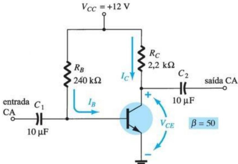
O circuito opera na região ativa pois  $V_{BE} > 0$  e  $V_{BC} < 0$  !
