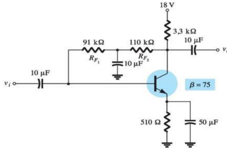
□ No modo CC o capacitor é um circuito aberto e  $R_B = R_{F1} + R_{F2}$
