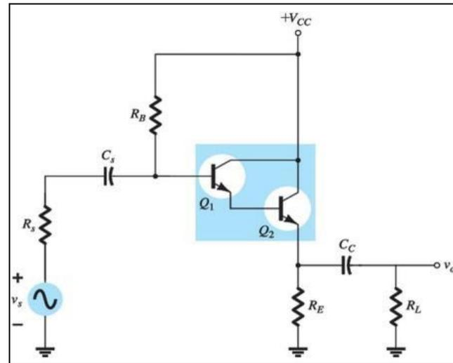
**2** Uma vez que a tensão de saída é retirada diretamente do terminal emissor mostra-se na **análise CA** que **o ganho é muito próximo de 1 e a impedância de entrada alta**.
