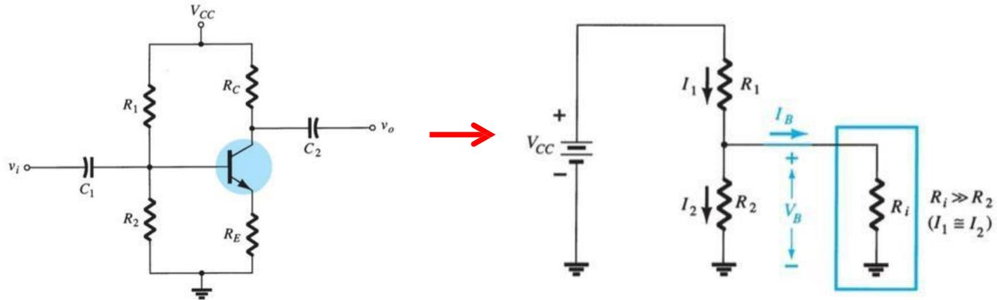
A resistência refletida ( $R_i$ ) entre a base e o emissor é  $R_i = (\beta + 1) R_E$ .
