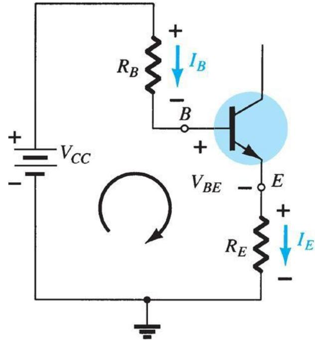
A diferença dessa equação de  $I_B$  e a obtida para a polarização fixa é o termo  $(\beta + 1)R_E$ .
