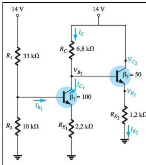
Estágio 1: Para a configuração de divisor de tensão as equações a seguir já foram desenvolvidas:
