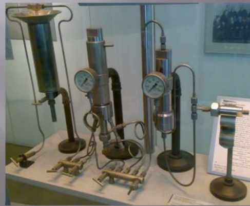
Aparelho de laboratório utilizado por Fritz Haber para sintetizar a amônia em 1909.
