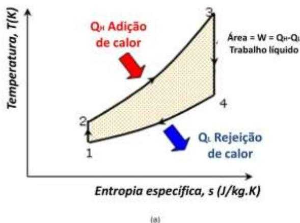
Fig. 19–Diagrama de temperatura versus entropia para o ciclo padrão a ar de um Ciclo Brayton simples
