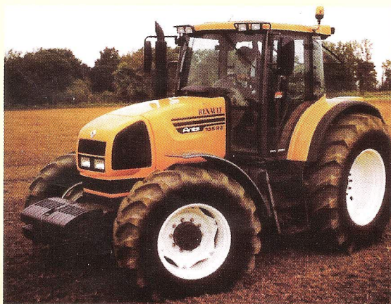
Fig. 12 - As cabinas têm incorporado em seu interior uma estrutura de proteção de 4 pontos ou um arco de proteção
