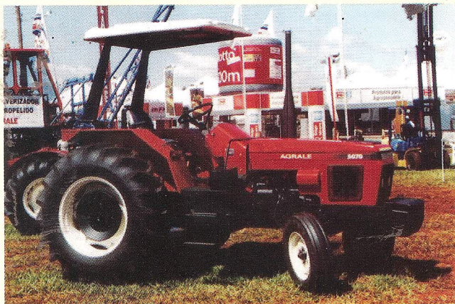
Fig. 9 - Estrutura de proteção contra sol e chuva através de capota
