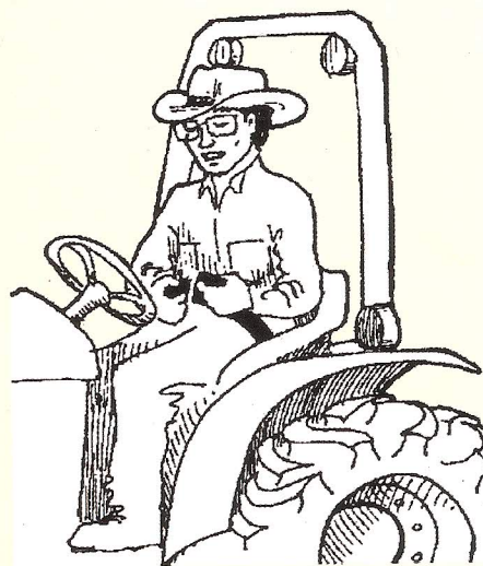
Fig. 8 - Operador protegido pela EPCC (no caso, arco de proteção) e pelo cinto de segurança
