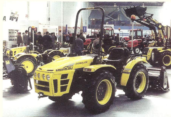
Fig. 11 - Estrutura de proteção contra capotamento do tipo arco de proteção
