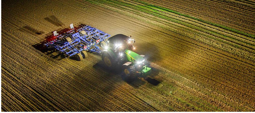
Figura 7 – A iluminação noturna reduz o desgaste do operador e permite que enxergue em distância adequada, evitando a ocorrência de acidentes.
