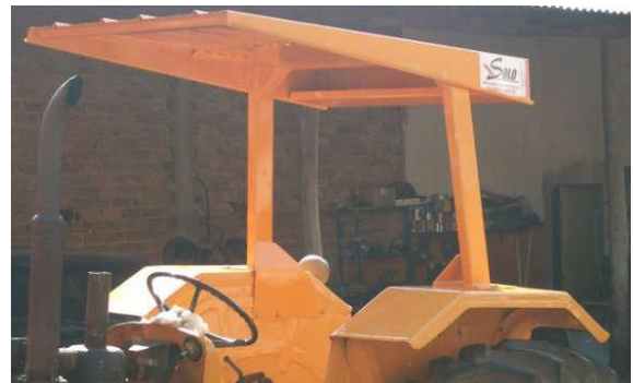
Figura 9 – Acima na esquerda, trator sem estrutura de proteção na capotagem e na direita EPC do tipo arco. Abaixo na esquerda cabine com EPC de quatro pontos e à direita anteparo para proteção contra o sol, sem qualquer efeito como EPC.
