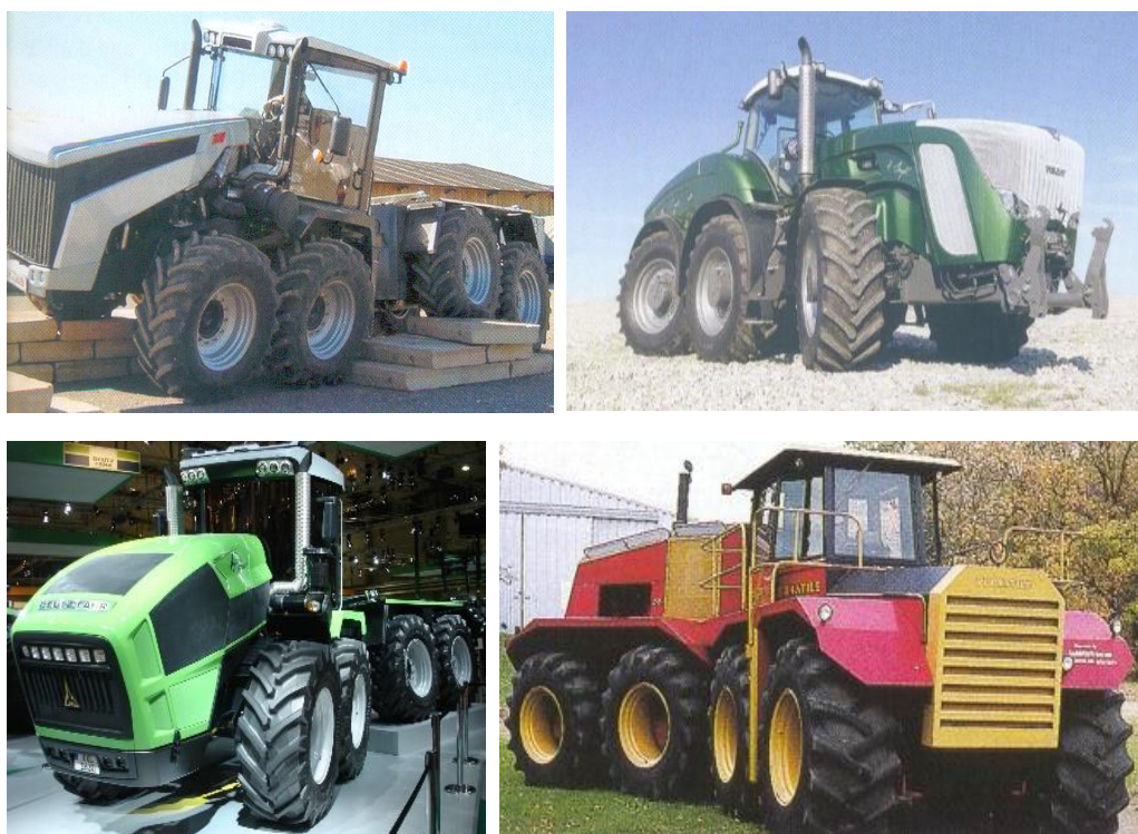
Figura 17. Exemplos de conceitos modernos de tratores tipo 6 x 6 e 8 x 8
