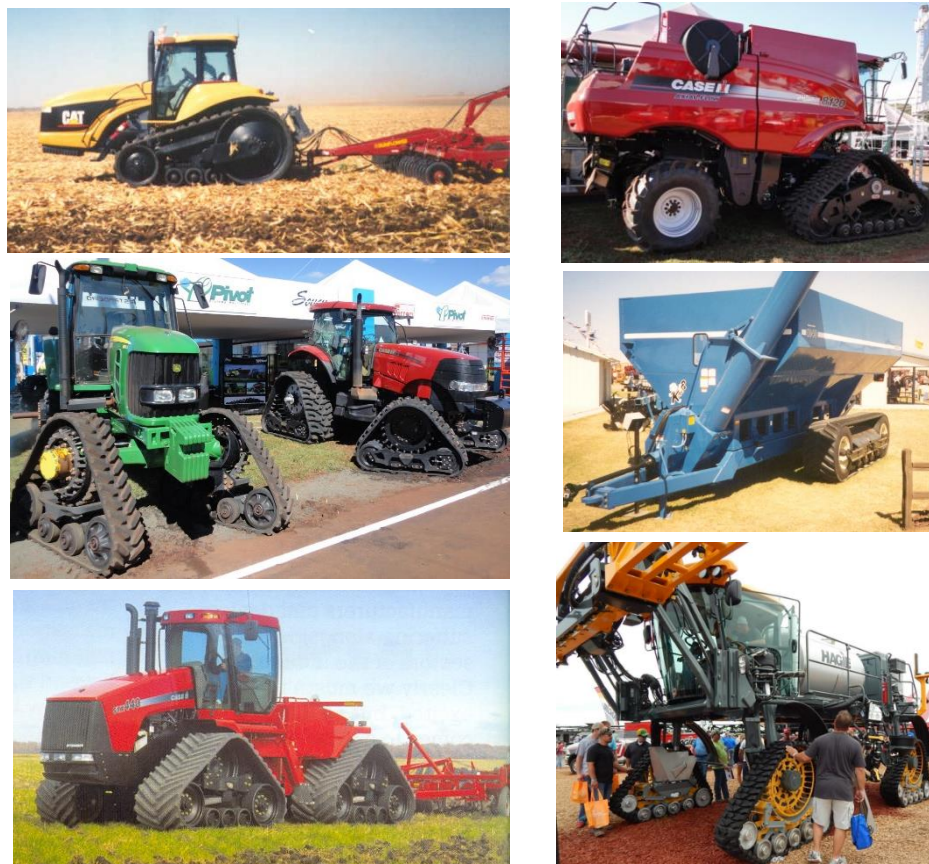
Figura 14. Exemplos de sistemas de rodados com esteiras de borracha em distintas aplicações
