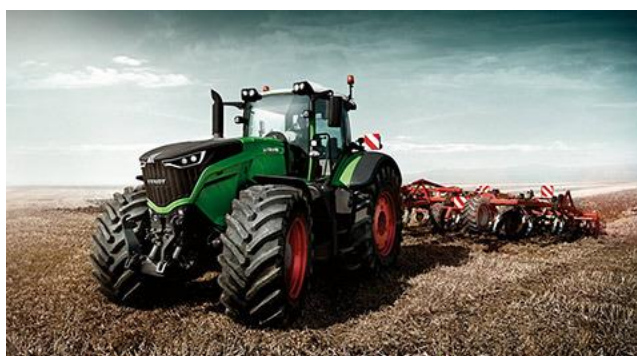
Figura 9. Trator 4 x 2 TDA de 500 hp (368 kW) de potência lançado em 2015 na Alemanha ( www.fendt.com )
