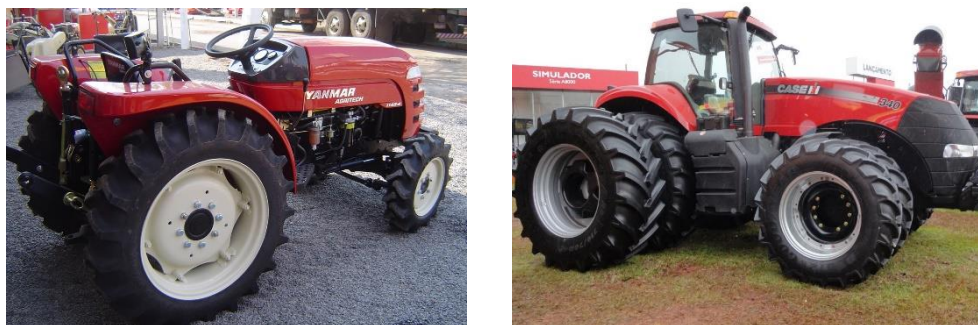
Figura 8. Exemplos de tratores 4 x 2 TDA de mercado, com baixa potência (50 hp) e elevada potência (340 hp)
