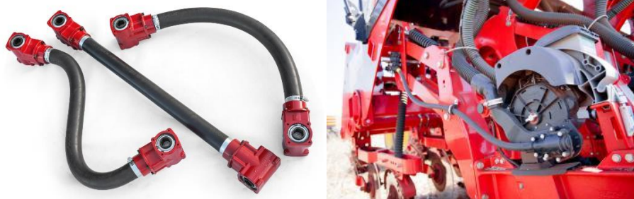
Figura 27. Transmissão com cabo (árvore) flexível recentemente muito utilizada em semeadoras de grãos para acionar o mecanismo dosador de cada linha, individualmente
