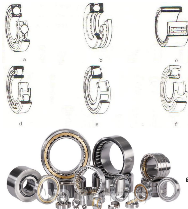
Figura 17. Mancal de rolamento radial de esferas (a); axial de esferas (b); de agulhas (c); de rolos cilíndricos (d); de rolos cônicos (e); contato angular de esferas (f); coletânea de rolamentos (g)
