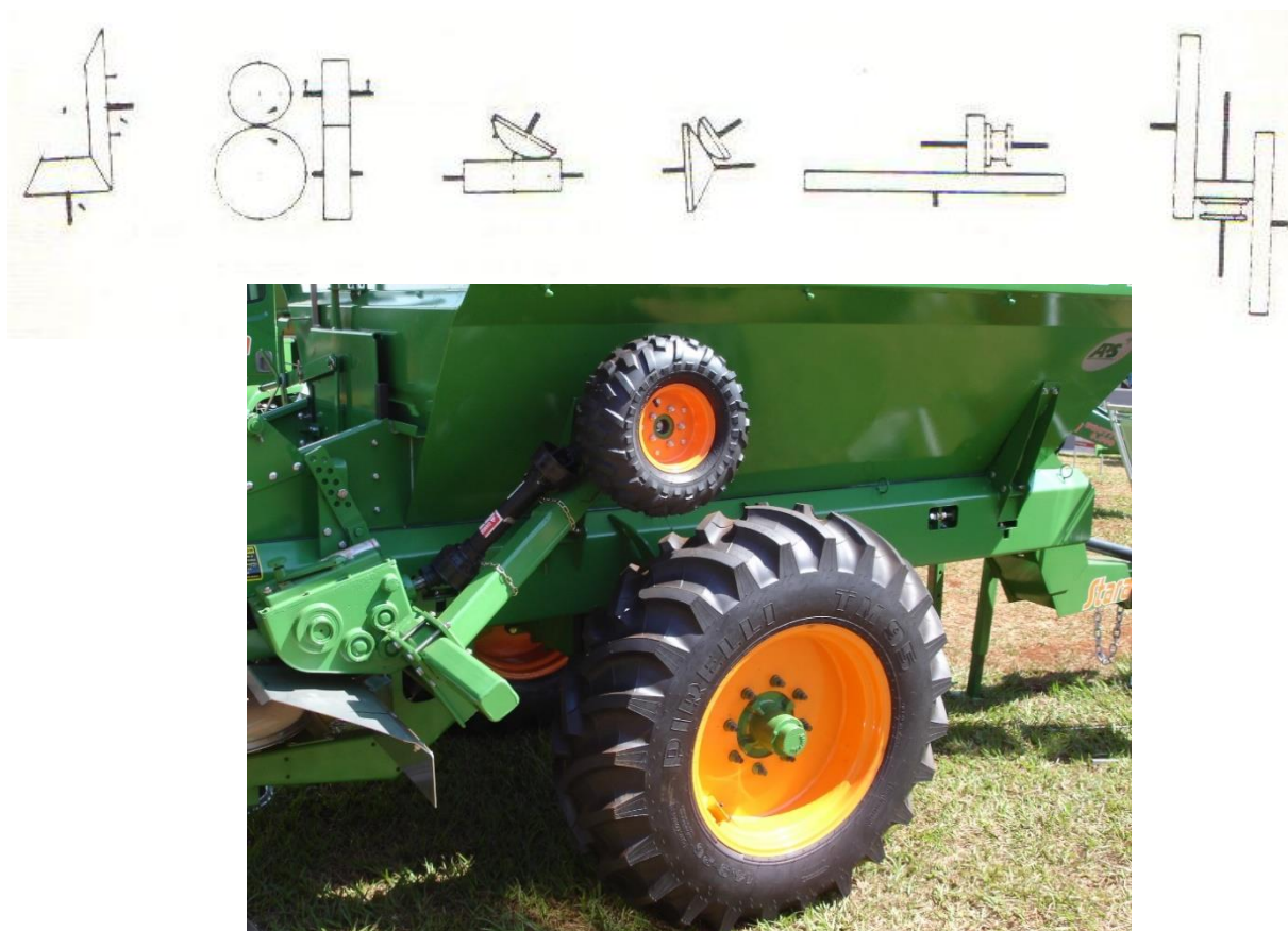
Figura 7. Diferentes tipos de arranjos de transmissões com rodas de atrito e exemplo de roda de atrito em uma adubadora, que em contato com o pneu, e com a máquina em movimento, passa a acionar o mecanismo que dosa a quantidade de adubo que será aplicada
