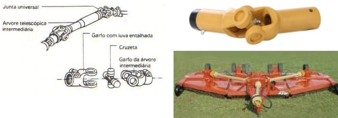
Figura 12. Junta universal e seus componentes e roçadora com sistema de transmissão de juntas universais e cardans
