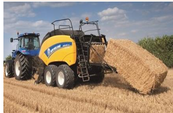
Figura 12 – Enfardadora e a operação de recolhimento e enfardamento de feno, parte dos processos ocorrem fora da máquina e parte em seu interior.
