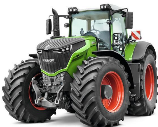
Figura 6 – Um trator em uso na atualidade. Com 368 kW de potência e transmissão hidráulica possuindo número ilimitado de marchas. A eletrônica embarcada controla a potência e força em função da operação realizada. Também possui sistema automatizado de direcionamento e telemetria para acompanhamento remoto.
