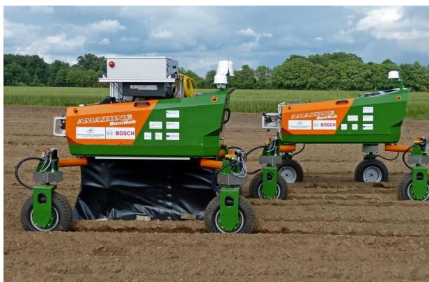
Figura 7 – Veículos autônomos utilizados no controle de plantas daninhas, mensuração da resistência mecânica do solo e fenotipagem automatizada. Estes equipamentos dispõem operadores.
