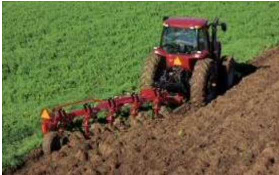
Figura 11 – Um arado de aivecas e a operação de aração, com o deslocamento do trator os órgãos ativos do implemento entram em contato do solo realizando o corte, elevação e inversão da camada de solo.
