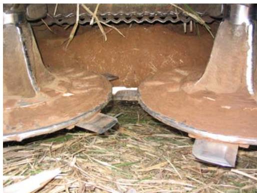
Figura 2 – Colhedora contaminada com impureza mineral aderida ao rolo alimentador e ao disco de corte basal à esquerda e ao capuz do extrator secundário à direita.
