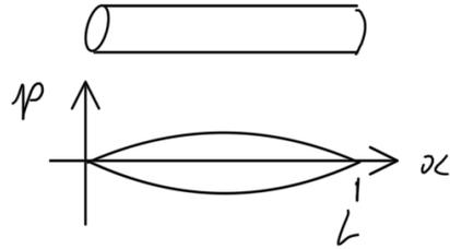
$$\Rightarrow L = \lambda/2, \text{ comprimento de onda } \lambda$$
