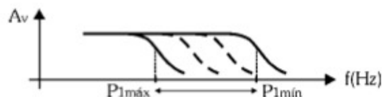
Figura 7.30 - Curva de resposta em frequência do controle de tonalidade.
