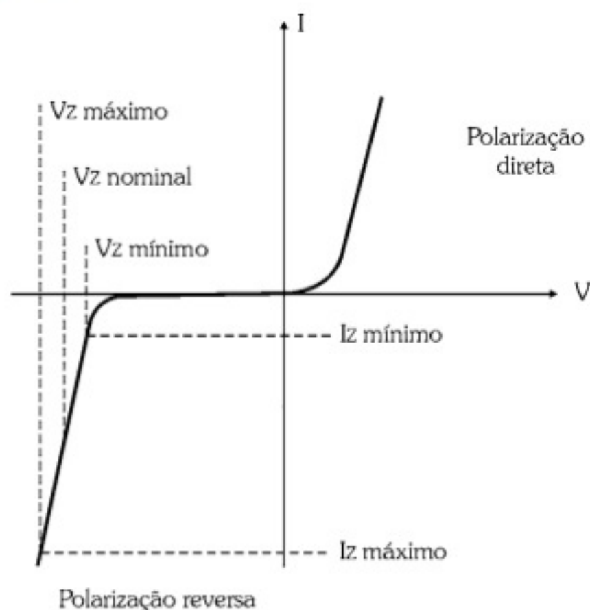
Figura 4.5 - Curva característica do diodo Zener.
