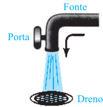
Figura 6.4 Analogia do fluxo de água para o mecanismo de controle do JFET.
