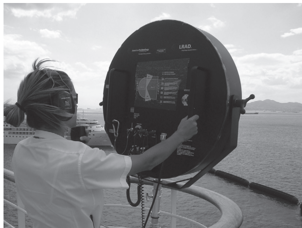
Figura 9.6 LRAD (dispositivo acústico de longo alcance) 1000X. (Cortesia de LRAD Corporation.)
