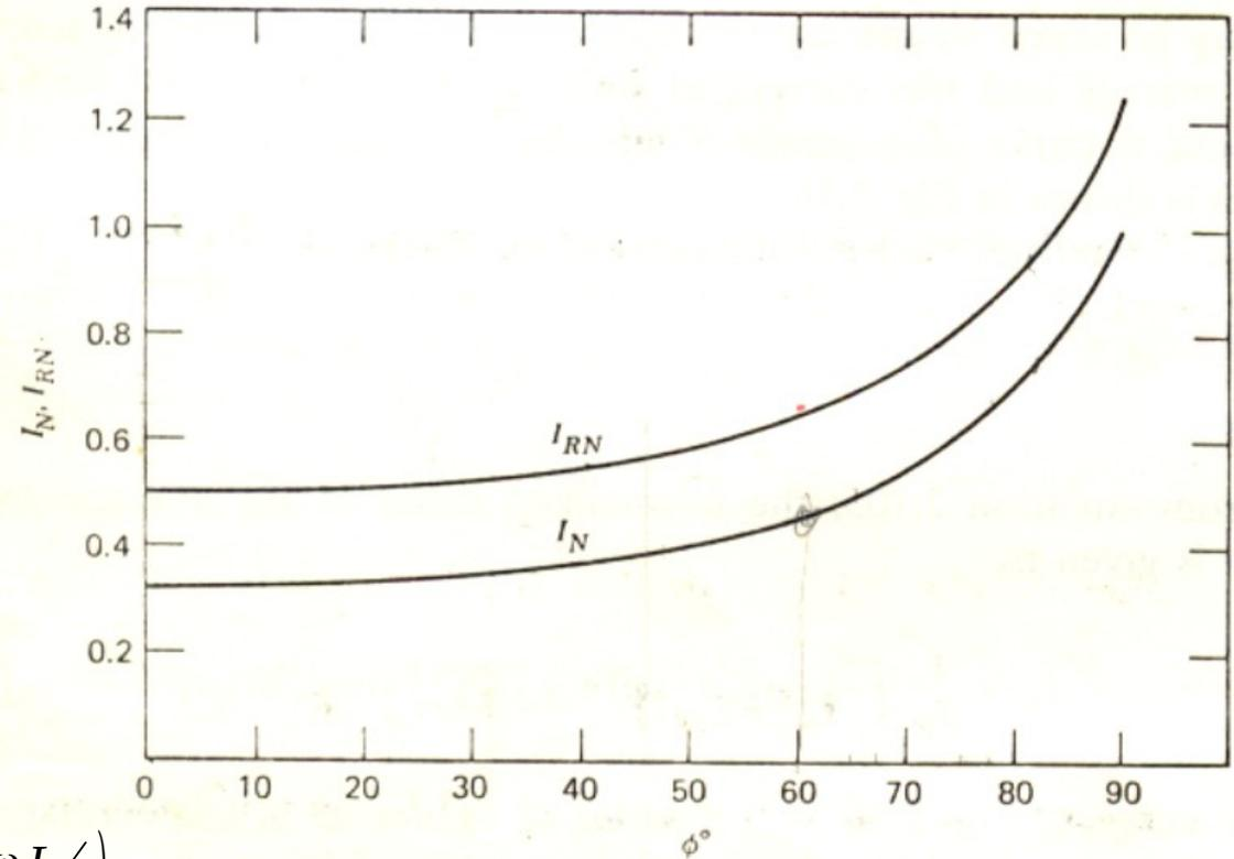
$$i_N = \text{sen}(\omega.t - \phi) + e^{-\omega.t / \tan \phi} \cdot \text{sen} \phi$$
