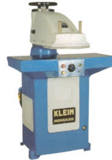
Para o corte de couro para a fabricação de sapatos.
