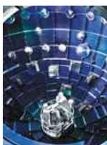
Pesquisadores investigando a fusão de núcleos de hidrogênio em uma câmara que focaliza os feixes de 192 lasers sobre um alvo no vácuo.
