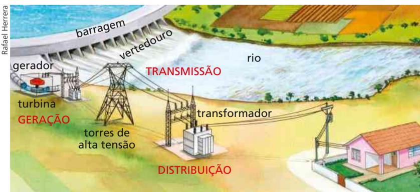
Geração, transmissão e distribuição de energia elétrica em uma usina hidrelétrica. Imagem com elementos sem proporção entre si e em cores fantasias.
