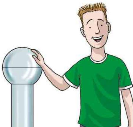
Cúpula eletrizada — os cabelos de uma pessoa, isolada, que encostar na parte externa da cúpula ficarão eletrizados e a repulsão entre as cargas irá arrepiá-los.
