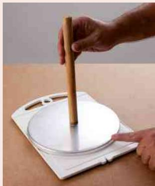
IV. Em seguida, o estudante deve erguer o disco metálico pelo cabo isolante. Aproximando os dedos da bandeja, o estudante pode produzir faíscas entre o disco metálico e o seu dedo ou até produzir uma centelha com uma lâmpada fluorescente.
