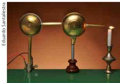
Na imagem, um condutor recebe carga continuamente de um gerador de Van de Graaff. A ionização próxima à ponta do condutor pode mover algumas camadas de ar e "soprar" a vela.
