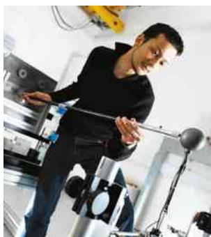
Calibração de um equipamento de radioterapia, para determinação da dosimetria (taxa de radiações) em uma exposição.
