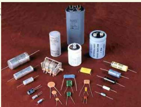
Há várias aplicações do capacitador como componente eletrônico e, por isso, os capacitadores assumem formas e tamanhos diferentes.
