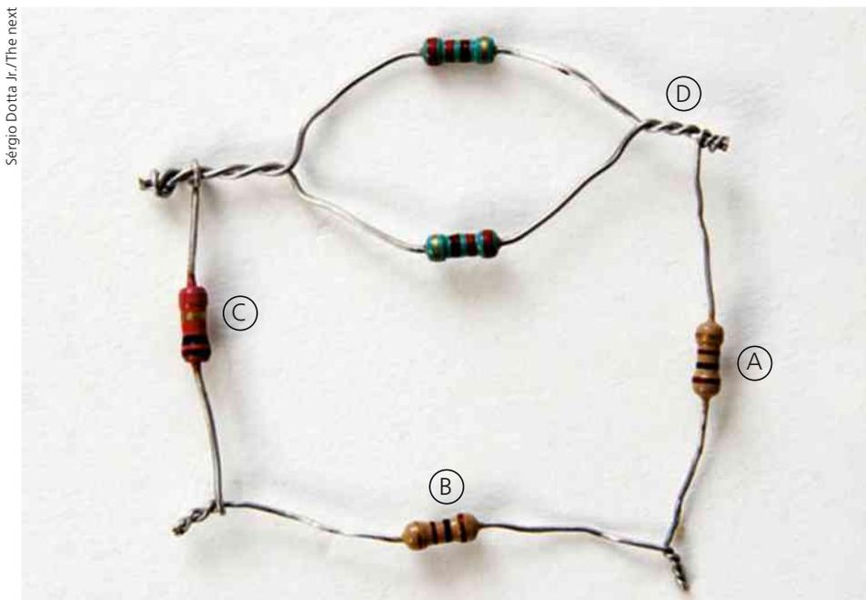
Neste trecho de circuito vemos uma associação de resistores. A corrente que atravessa o trecho AB só pode fazê-lo de uma maneira. Para atravessar o trecho CD, a corrente vai se dividir.
