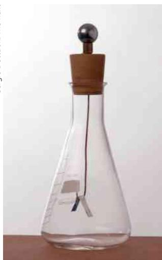
Um eletroscópio de fácil construção.
