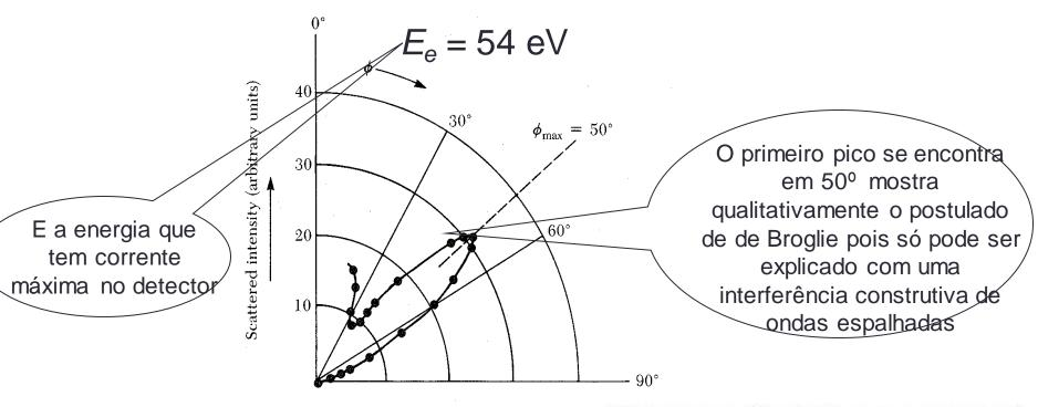
Eles observaram que, para elétrons com energia de 54 eV, a quantidade de elétrons espalhados apresentava picos em função do ângulo, como no caso de uma figura de difração
