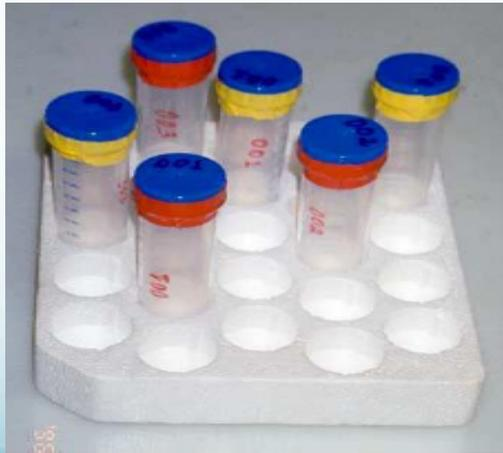
Amostras de água acondicionadas na bandeja de isopor
