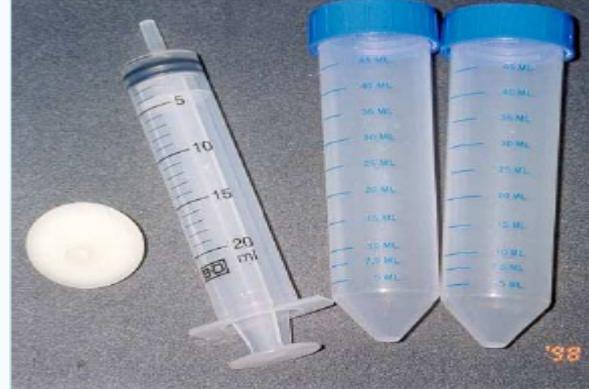
Material para coleta de água: 2 tubos para centrífuga, unidades filtrantes e seringa descartável sem agulha
