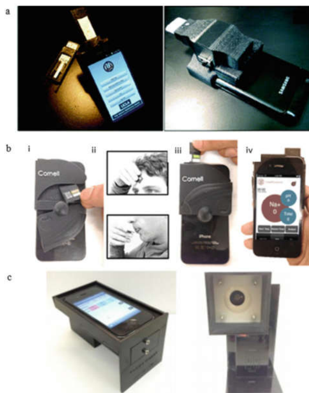
Fig. 3.18 Leitores externos acoplados a smartphones para PADs colorimétricos; (a) um leitor óptico instalado em um telefone Android (Samsung Galaxy S II) para diagnóstico rápido de malária, tuberculose, e HIV [162]; (b) um acessório de smartphone integrado para monitorar mudanças no suor e pH salivar [163]: (i) uma capa de smartphone com um compartimento de armazenamento para tiras de teste, (ii) amostragem métodos para amostras de suor e saliva, (iii) inserção de uma tira de teste para aquisição e leitura de dados, (iv) os resultados são analisados usando um aplicativo para iPhone especialmente desenvolvido e exibidos na tela; (c) o combinação entre PADs colorimétricos e um smartphone para determinação de explosivos [164], reproduzido com permissão das referências [162–164], respectivamente.
