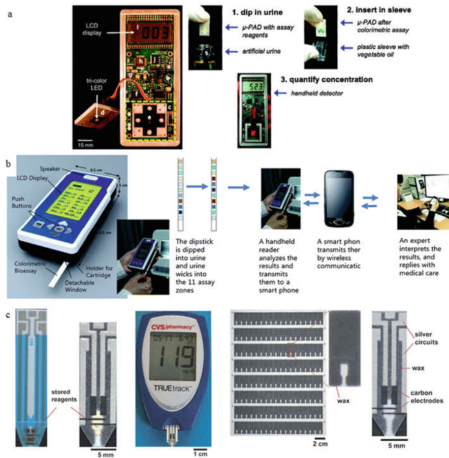
Fig. 3.17 Leitores portáteis para PADS. Para ensaios colorimétricos, os colorímetros ópticos portáteis são desenvolvidos para quantificar ensaios colorimétricos por meio de (a) medições baseadas em transmitância [153] ou (b) medições baseadas em refletância [154], (c) um glucosímetro comercial empregado como um leitor portátil para ePADs para medir quantitativamente glicose, colesterol, lactato e álcool em sangue e urina [155], reproduzidos com permissão das referências [153–155], respectivamente
