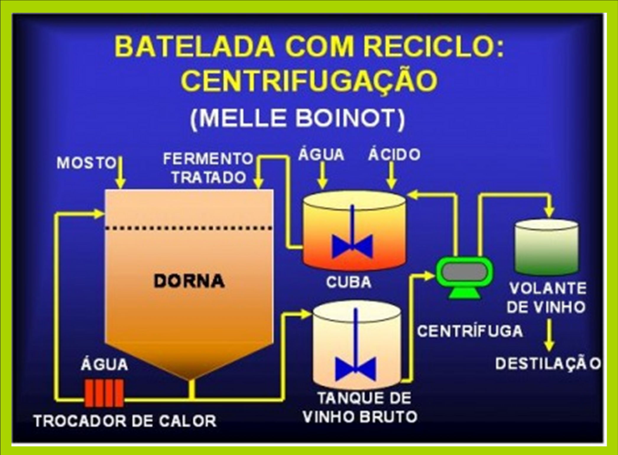
Sistema de recuperação de leveduras
