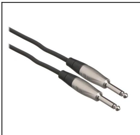
**TS, Jack** ou **"Banana mono"**: São semelhantes ao TRS, mas só possuem os terminais T e S (tip e sleeve). Como só possuem duas vias, são usados para sinais mono e não balanceados. São os cabos usados em instrumentos como guitarras elétricas e captadores.
