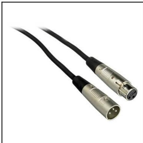
**XLR** ou **Canon**: São conectores com cabos de 3 vias e, portanto, balanceados. São o padrão para uso em microfones e bastante usados quando os cabos são muito longos. É um plug robusto e alguns tem uma pequena trava que impede que se soltem do painel. Vêm em duas versões: macho (usado para saída de áudio) e fêmea (usado para entrada de áudio).
