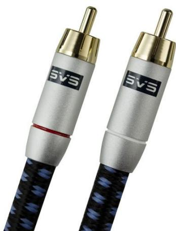
**RCA, Phono:** São conectores de 2 vias (portanto, não balanceados), geralmente usados em tocadiscos e equipamentos domésticos. Seus contatos com os terminais nem sempre são precisos e devem ser usados em distâncias curtas. Foram muito usados em aparelhos de vídeo e televisores, geralmente usando cores (vermelho para o áudio esquerdo, preto ou branco para o direito, amarelo para o sinal de vídeo).
