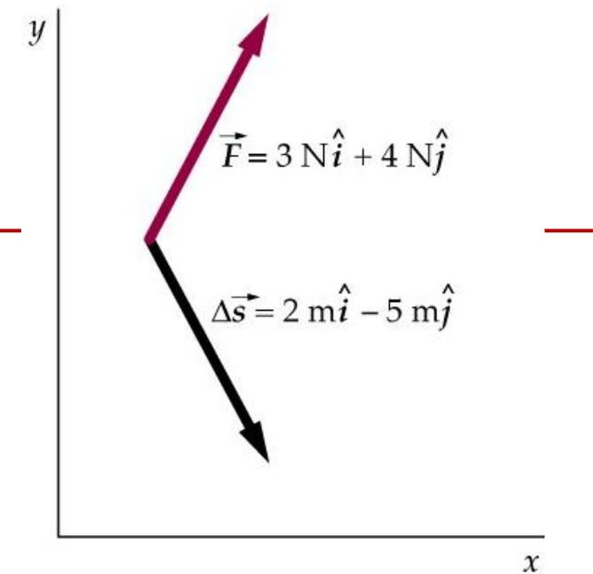
(b) a componente da força na direção do deslocamento.
