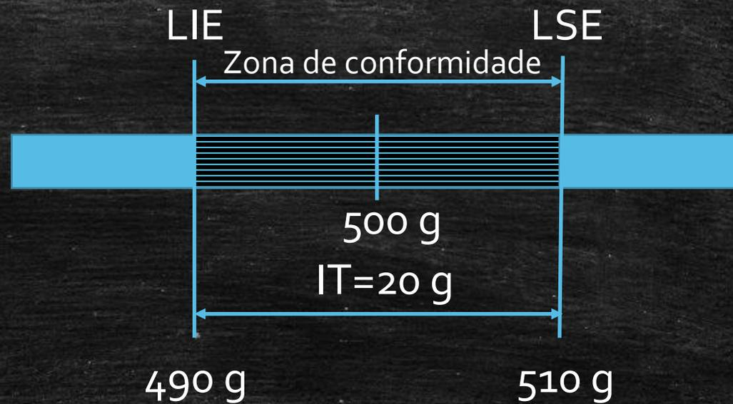
Limite inferior da especificação (LIE), limite superior da especificação (LSE) e intervalo de tolerância (IT) para a tolerância de  $500 \pm 10$  g
