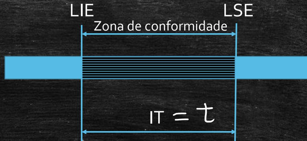
Limite inferior da especificação (LIE), limite superior da especificação (LSE) e intervalo de tolerância (IT) para a tolerância de  $500 \pm 10$  g
