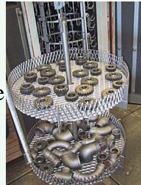
Jateamento com areia em câmara fechada
