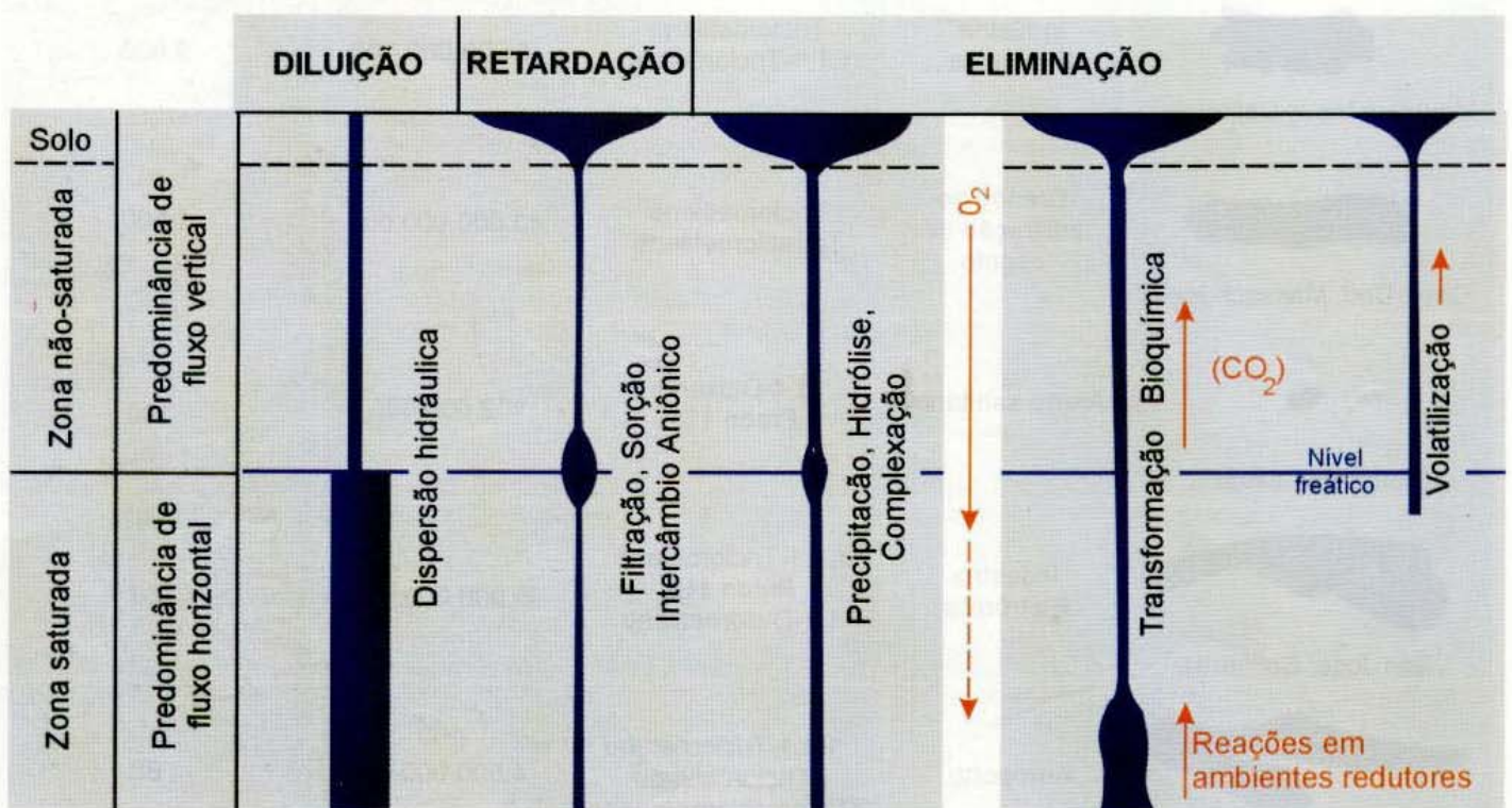
Fig. 20.9 Perfil de degradação do solo e zona saturada e não-saturada. A espessura da linha corresponde a maior ou menor atuação do processo indicado.
