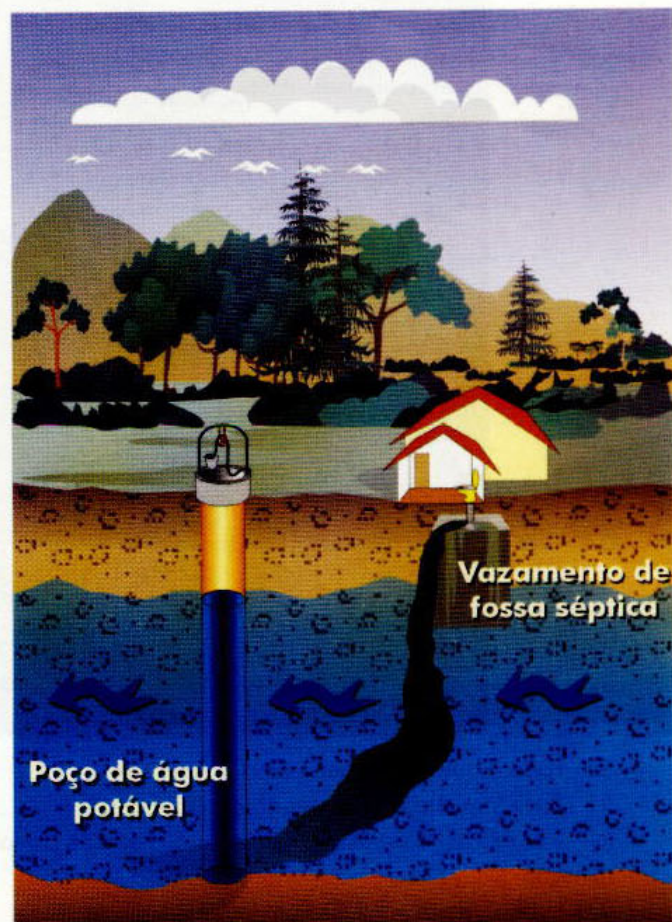
Fig. 20.10 Contaminação da água subterrânea por fossas sépticas e negras.
