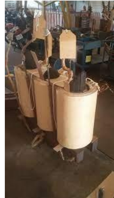
Enrolamentos do Transformador de Potência
