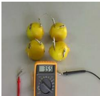
Figura 11 – Prática 5: Montando uma pilha com um limão
