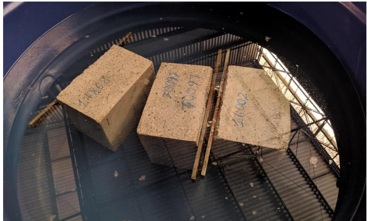
Placas submersas em água
