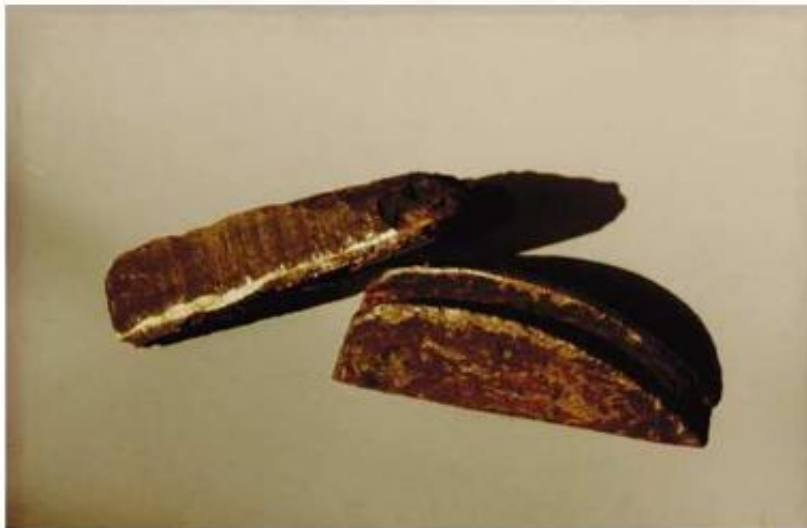
Corrosão gráfica em componente de bomba centrífuga de ferro fundido: parte escura, área corroída, devida à grafite.
