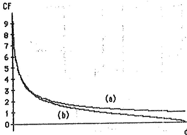
Figura 2. Factor de crista de ondas rectangulares em função de  $d$ :
