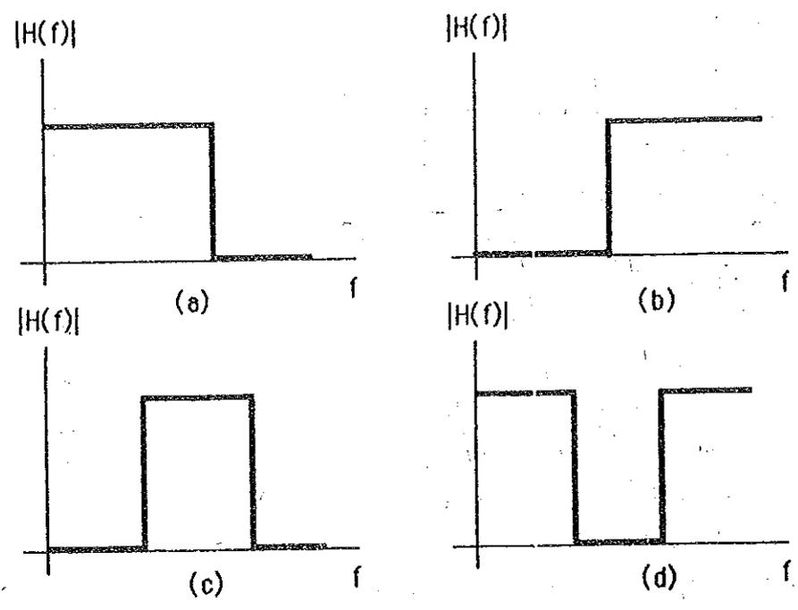
Figura 4. Filtros ideais: a) passa-baixo; b) passa-alto; c) passa-banda; d) rejeição de banda.
