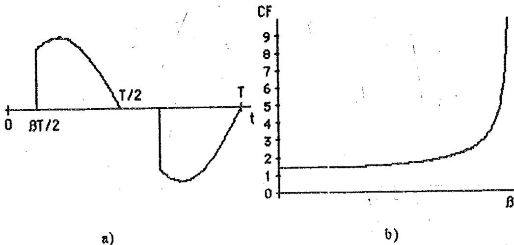
Figura 3. a) Onda sinusoidal comutada; b) respectivo  $CF(\beta)$ .
