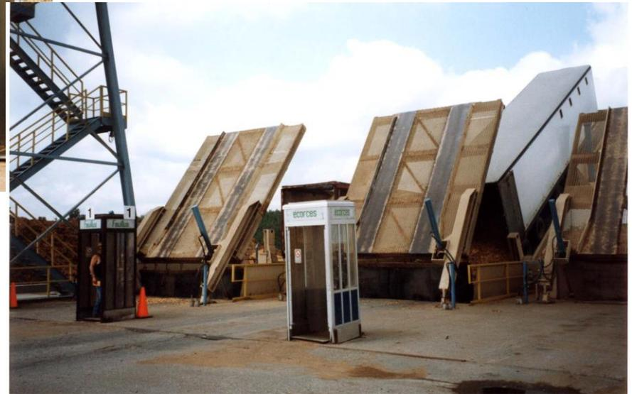
**Contêiner de cavacos sobre plataforma (Esq.) e elevação da plataforma e descarregamento dos cavacos (Dir.).**
