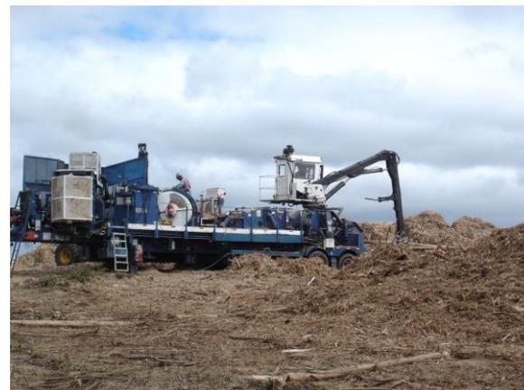
Figura 11. Módulo mecanizado de produção de cavacos no campo: feller buncher Timberjack 608S, “clam bunk” skidder Timberjack 1710 D, “delimber/debarker/chipper” DDC 5000 G, carreta para transporte de cavacos (sentido horário).
