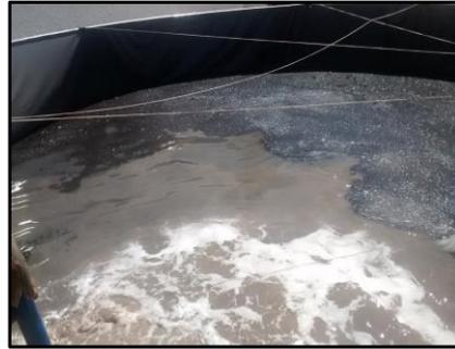
\* Biorreator para crescimento de microbiota selecionada de sítio contaminado (Processo BiogeoTec/Microbiol)
