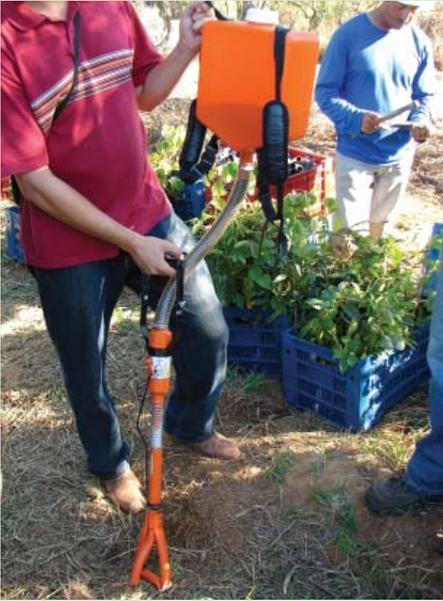
**Figura 6.3:** Equipamento costal para aplicação de iscas a granel.
